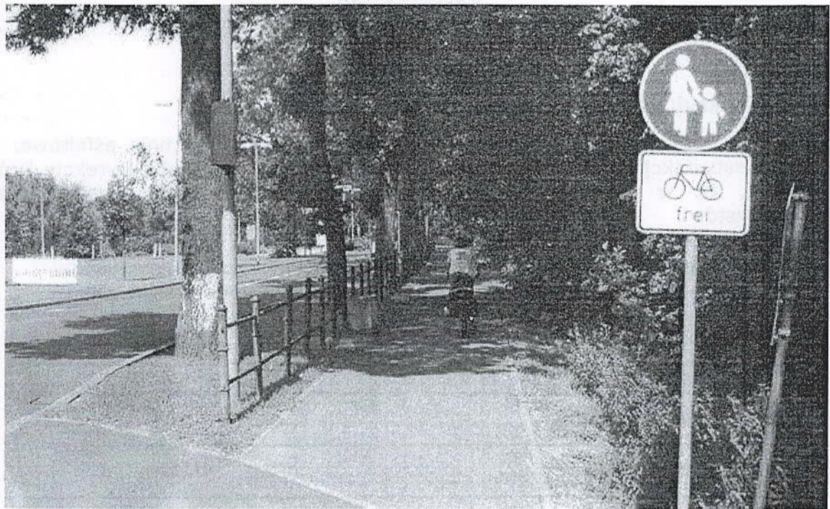
Rysunek 7. Ze względu na nawierzchnię z kostki betonowej ścieżka rowerowa wzdłuż drogi federalnej nr 166 (Niemcy) została przekwalifikowana na ciąg pieszy z dopuszczonym ruchem rowerów (bez obowiązku korzystania).
